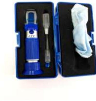
Figure 10 : Réfractomètre
