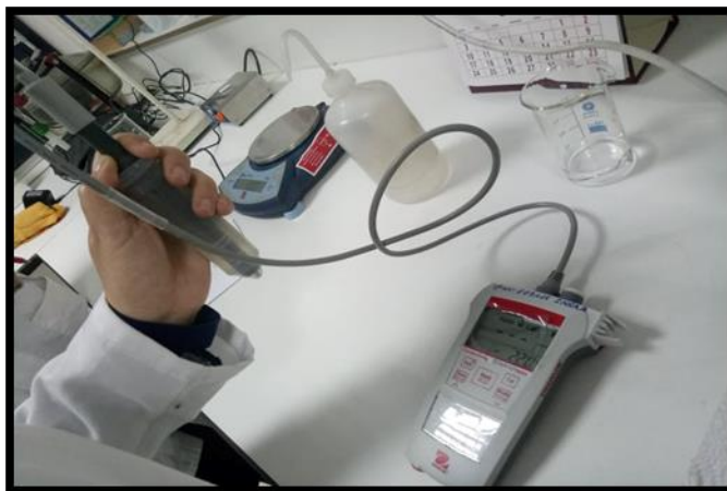
Figure 10 : Détermination de la conductivité électrique du miel (REGUIG, 2019)
