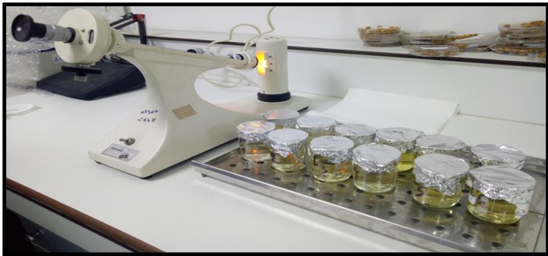
Figure 12: Analyse de la rotation spécifique des miels par Polarimétrie (REGUIG, 2019)
