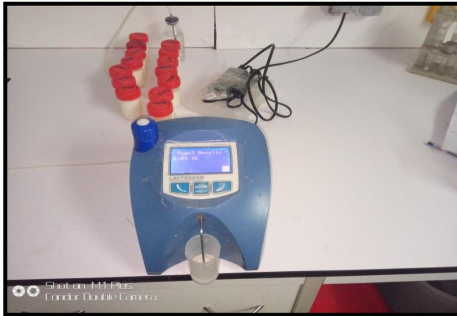
**Fig .14 :** Mesure de lactose et protéine du lait de vache par le lactoscan SP
