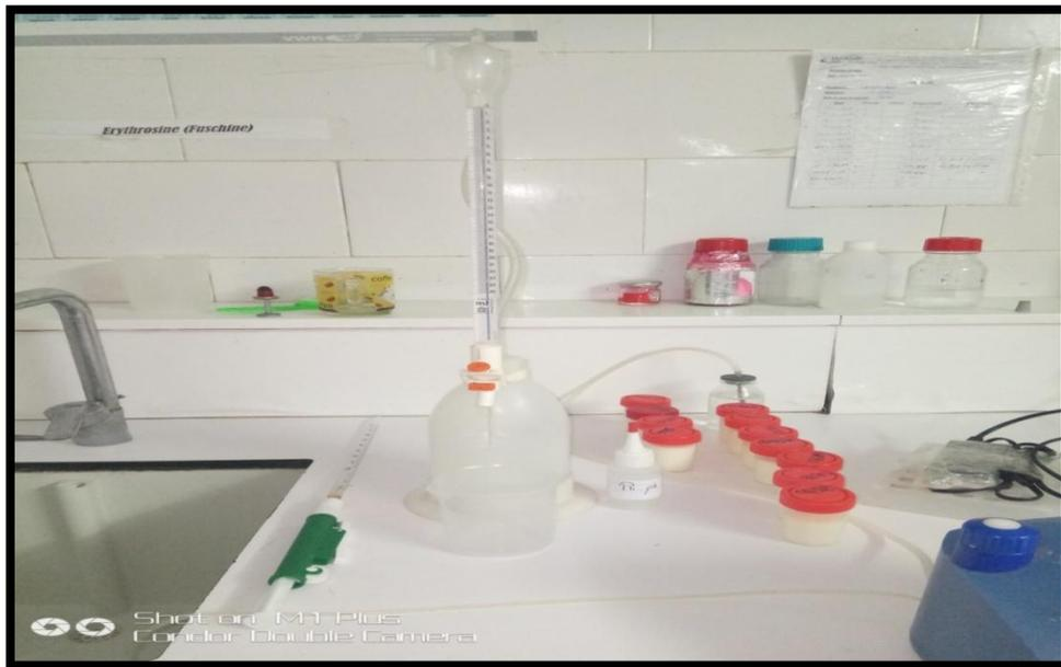
**Fig .12** : Mesure de l'acidité titrable du lait de vache (photo personnelle, 2019).
