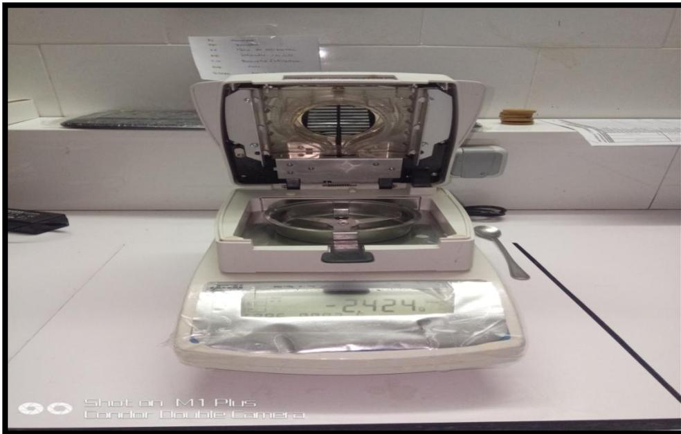
**Fig .15** : Mesure de EST du lait de vache par le dessiccateur à balance de type (SARTORIUS MA 30) (photo personnelle, 2019).
