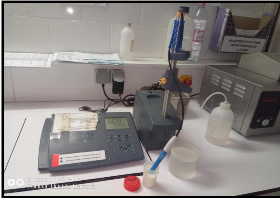
**Fig .11** : Mesure de ph du lait de vache laiti re (photo personnelle, 2019).
