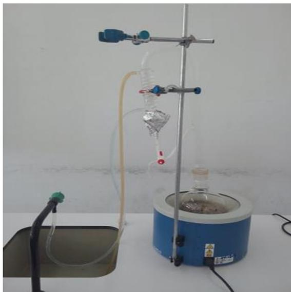
**Figure 2.** L'appareil utilisé pour l'extraction des huiles essentielles par hydro distillation.
