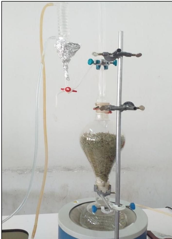
**Figure 1 :** Montage d'extraction des huiles essentielles de type Clevenger
