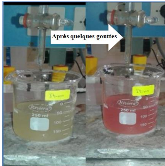
Figure 7. Titrage volumique de l'extrait de la datte.
