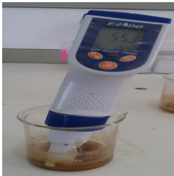
Figure 5 : Mesure du pH de l'échantillon à l'aide d'un pH-mètre.
