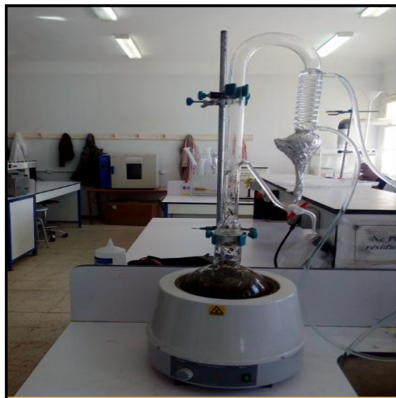
Figure 9. Montage d'hydrodistillation de type «Clevenger 1928».
