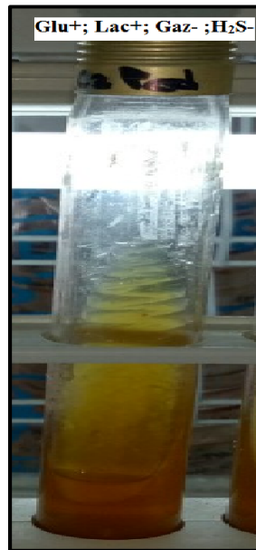
Figure N°16 Résultat de test de TSI pour la souche GC1.
