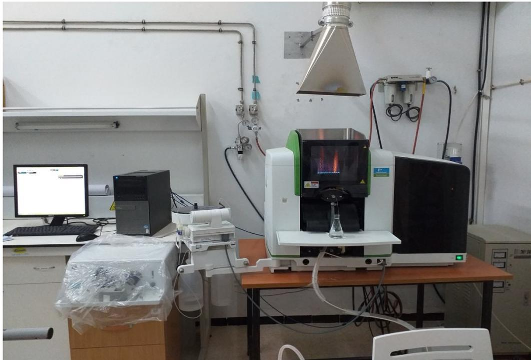
**Figure 2.5.** Spectromètre d'absorption atomique à flamme (FAAS) (Photo original)
