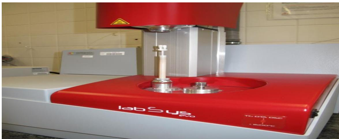
Figure II. 2 : Appareil ATD/ATG utilisé LabSys
