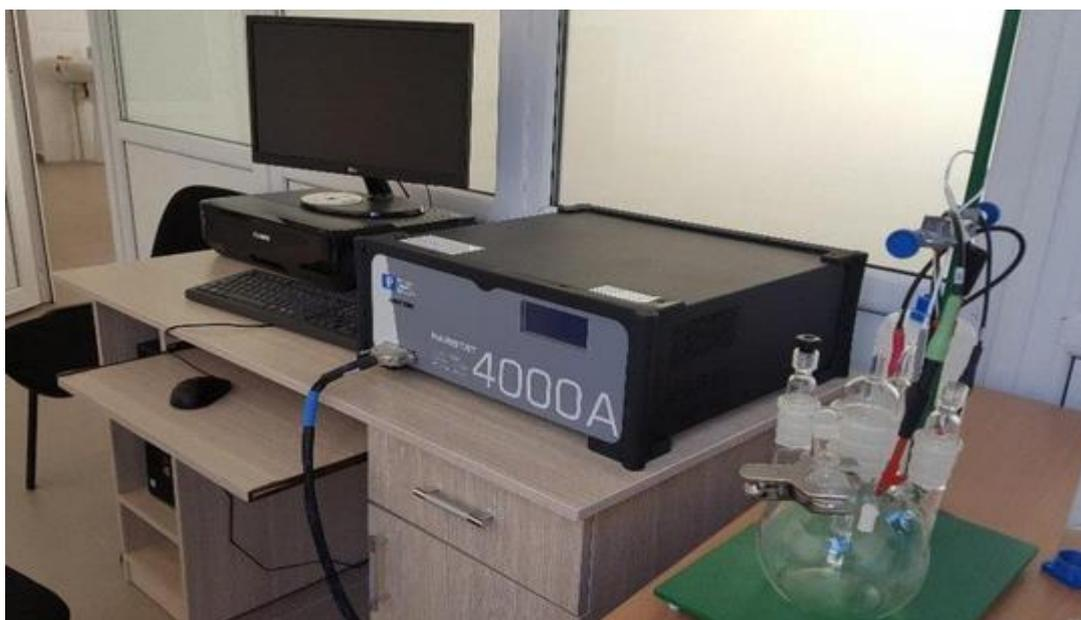
**Figure II.7:** PARSTAT 4000A Potentiostat Galvanostat
