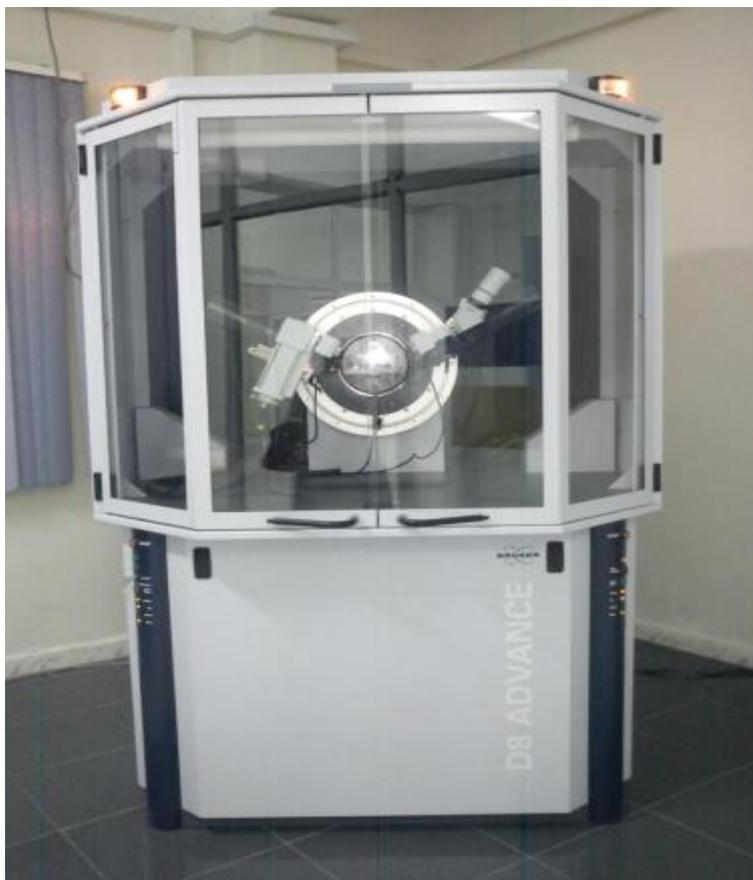
**Figure II.4 :** Le diffractomètre des rayons X
