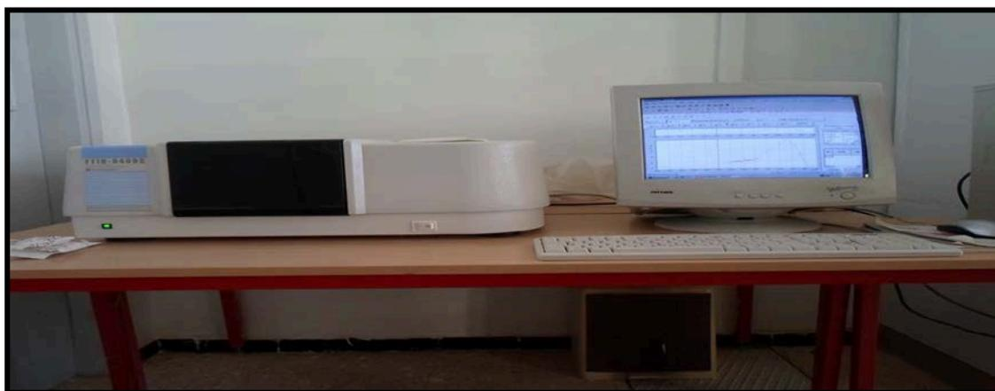
**Figure II .6:** spectromètre Infrarouge à transformée de Fourier FTIR-Shimadgu 8400S
