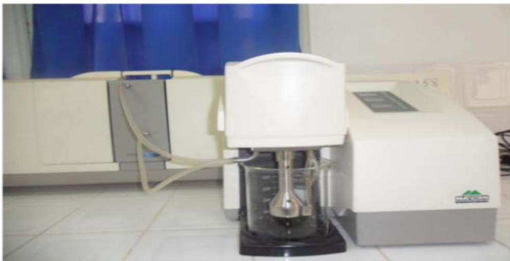
**Figure II.5:** Granulomètre laser Malvern Mastersizer 2000- Hydro 2000G
