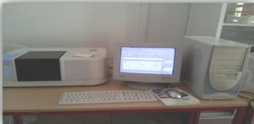
**Figure II.23: Spectromètre Infrarouge à transformée de Fourier FTIR- Shimadzu 8400S.**
