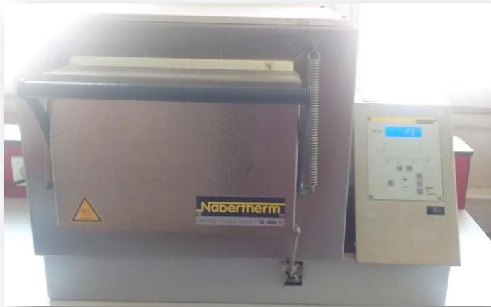
Figure II.11 : Four programmable de marque Nabertherm.
