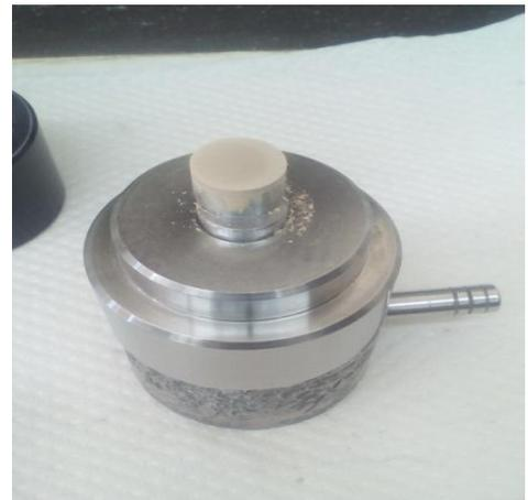
**Figure II.16 : compactage de la poudre forme cylindrique.**
