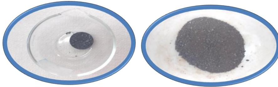
**Figure II.13 : Rebroyage après l'étape de calcination.**
