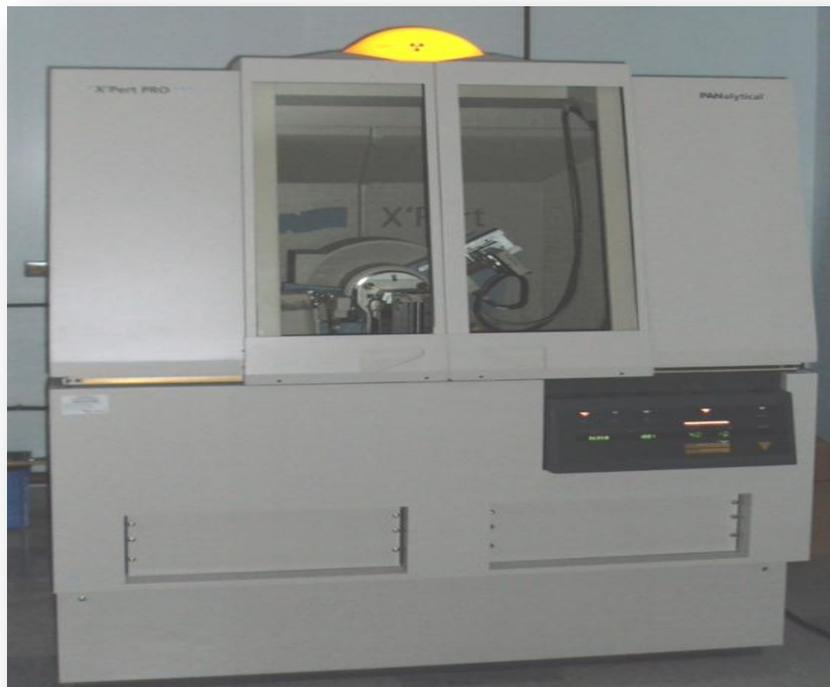
**Figure II. 22:Diffractomètre de type X'pert pro analytical.**
