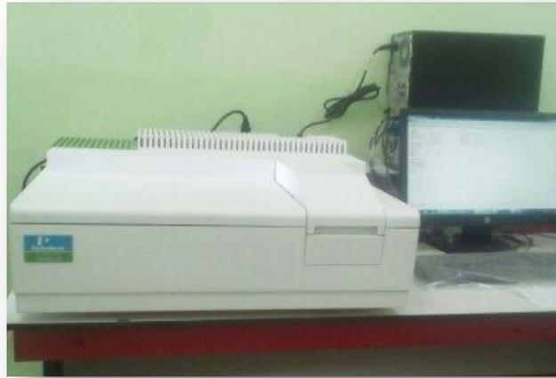
**Figure II.24: Spectromètre UV- visible type « Perkin Elmer Lambda 25 UV ».**
