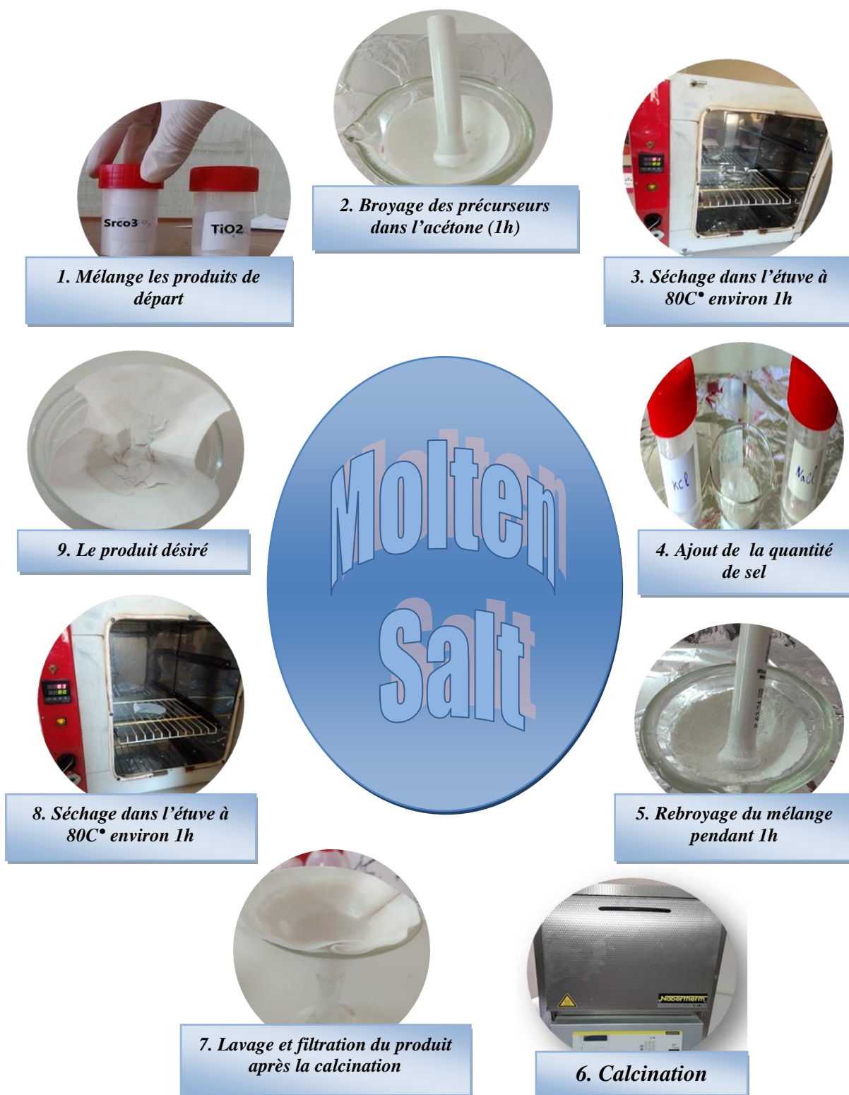
Figure III.2: Les différentes étapes de synthèse du composé \text{SrTiO}_3 par la méthode Molten Salt.
