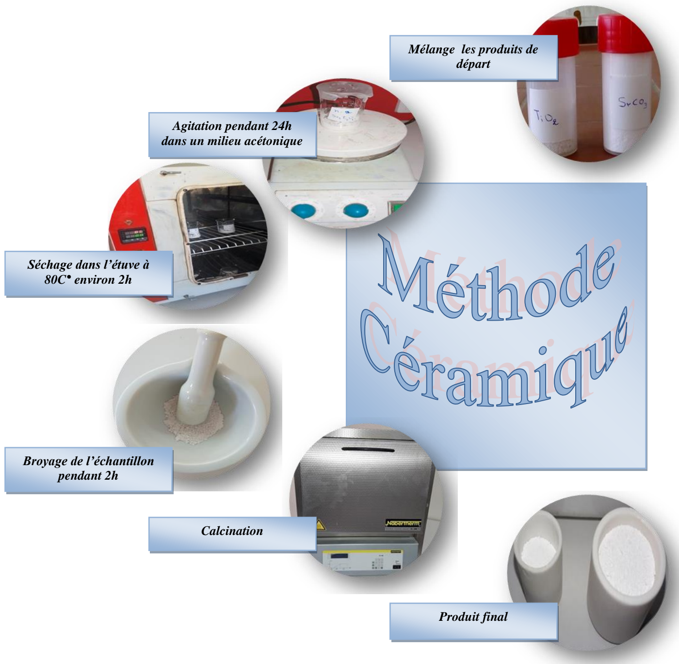
Figure III.1: Les différentes étapes de synthèse des composés Sr_{n+1}Ti_nO_{3n+1} par voie solide.
