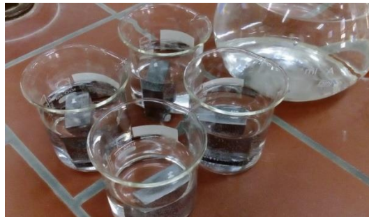
Figure 47 : l'acier x60 dans milieu acide HCl sans inhibiteur.
