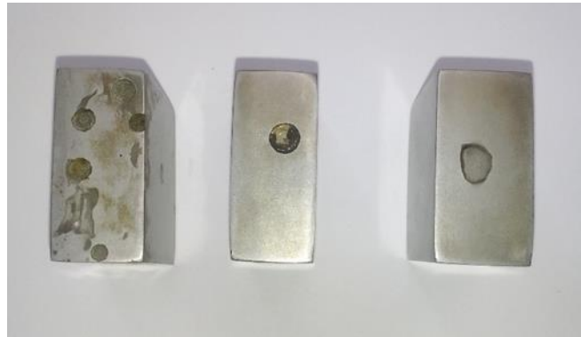
Figure 50 : l'acier X60 corrosion par piquer.
