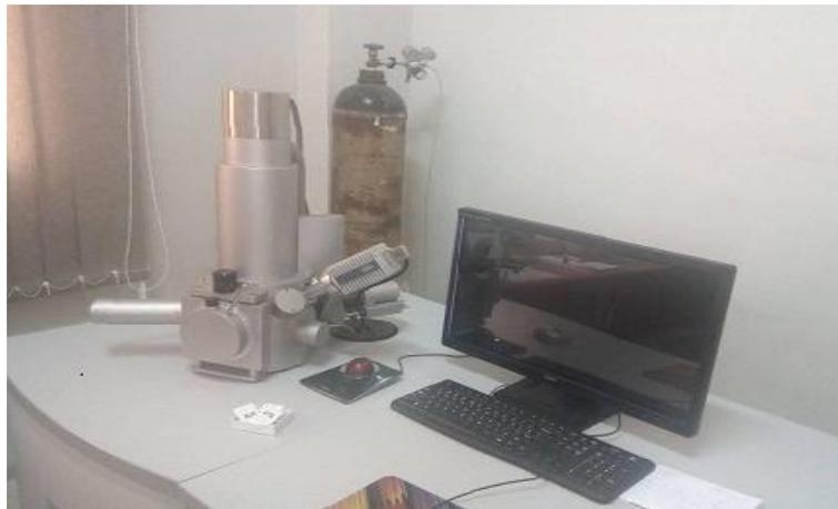
**Figure. II.6 : une microscopie électronique à balayage (MEB) de type TESCAN VEGA3.**
