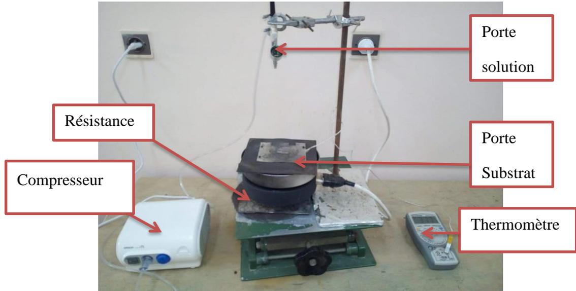
**Figure II.1:** Dispositif complet de dépôt de couches minces par la méthode spray pneumatique.
