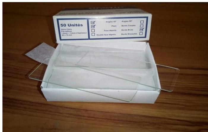
**Figure II.4 :** Le type de substrat utilisé.
