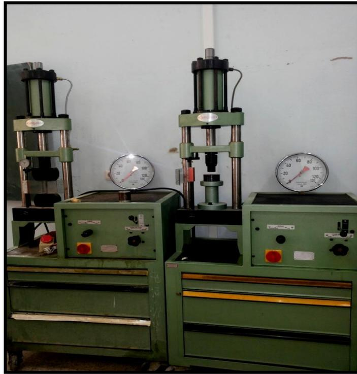
**Figure II.2.** Machine utilisée pour la compression des échantillons.
