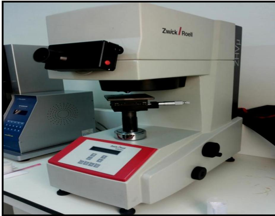
**Figure II.6.** Duromètre Zwick Roell de type ZHV $\mu$  (Laboratoire Physique des Couches Minces et ses Applications Univ-Biskra).
