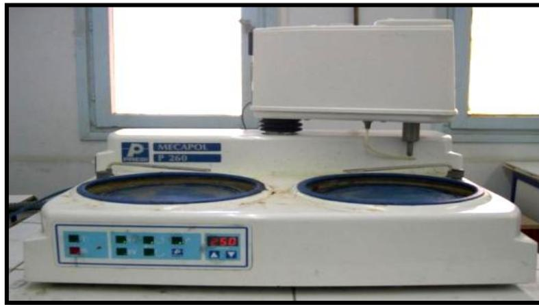
**Figure II.3.** Polisseuse mécanique de type PRESI MECATECH P260 (Laboratoire de Physique, Univ-Biskra).
