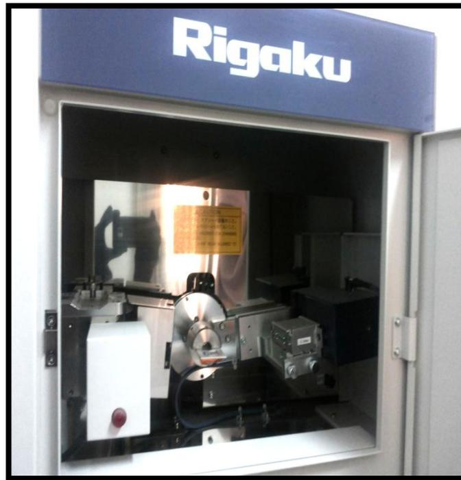
**Figure II.7. Diffraction des rayons X (DRX)** (Laboratoire de Physique des Couches Minces et Applications univ-Biskra).
