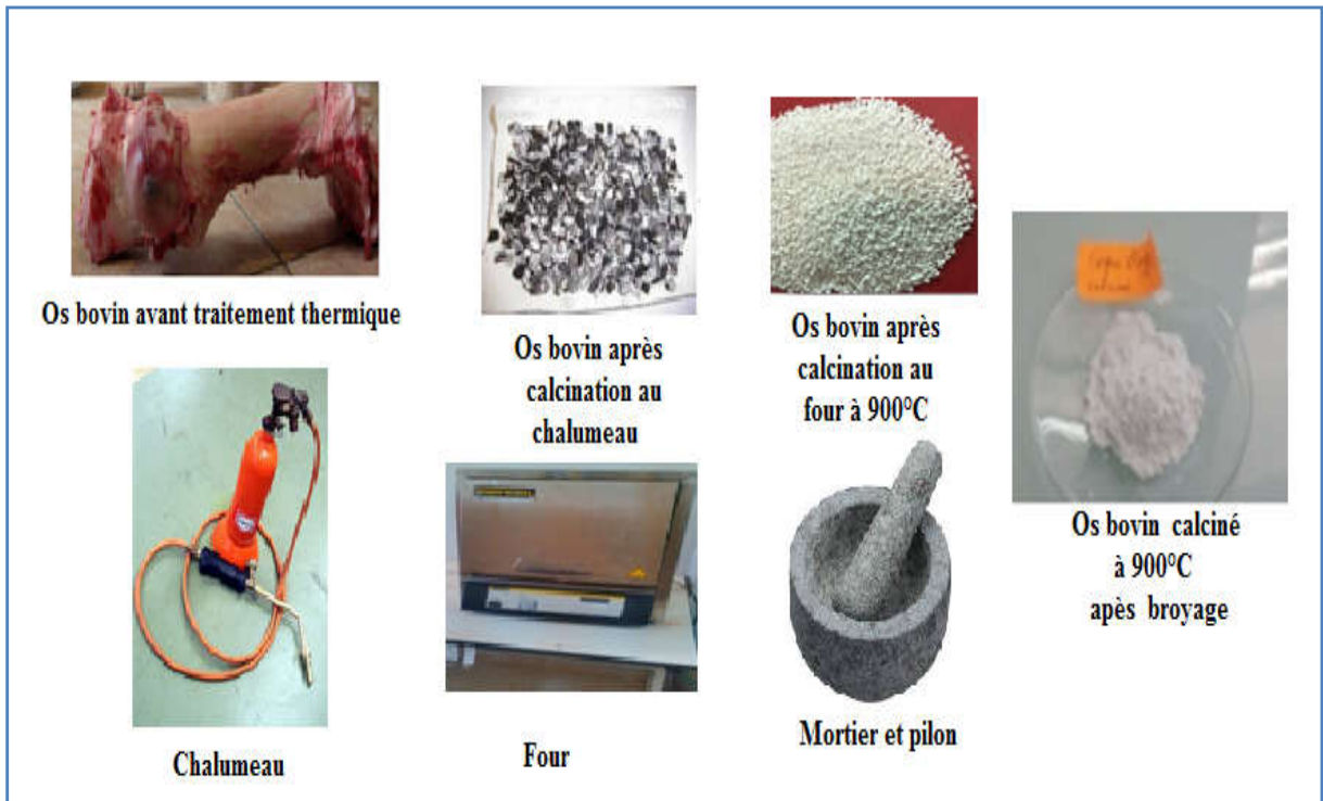
Figure II.2 : Schéma résumant les étapes de préparation de HAP à partir de l'os bovin.
