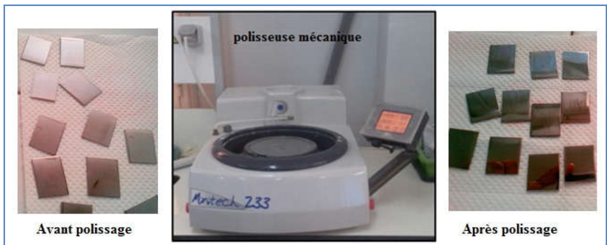
Figure III.2 : Etat de surface avant et après polissage.
