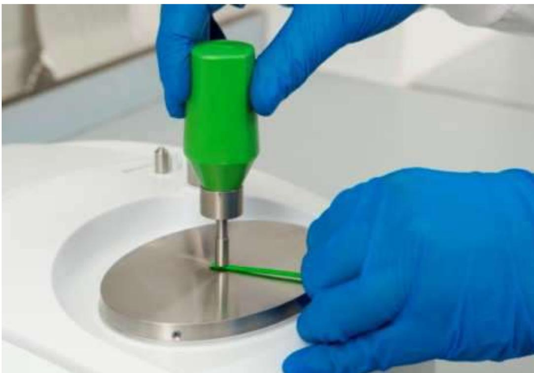
**Figure II.11:** Techniques de l'UATR du spectrophotomètre Perkin Elmer. Spectrum Two.
