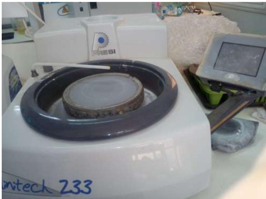
**Figure II.4:** polisseuse MECAPOL
