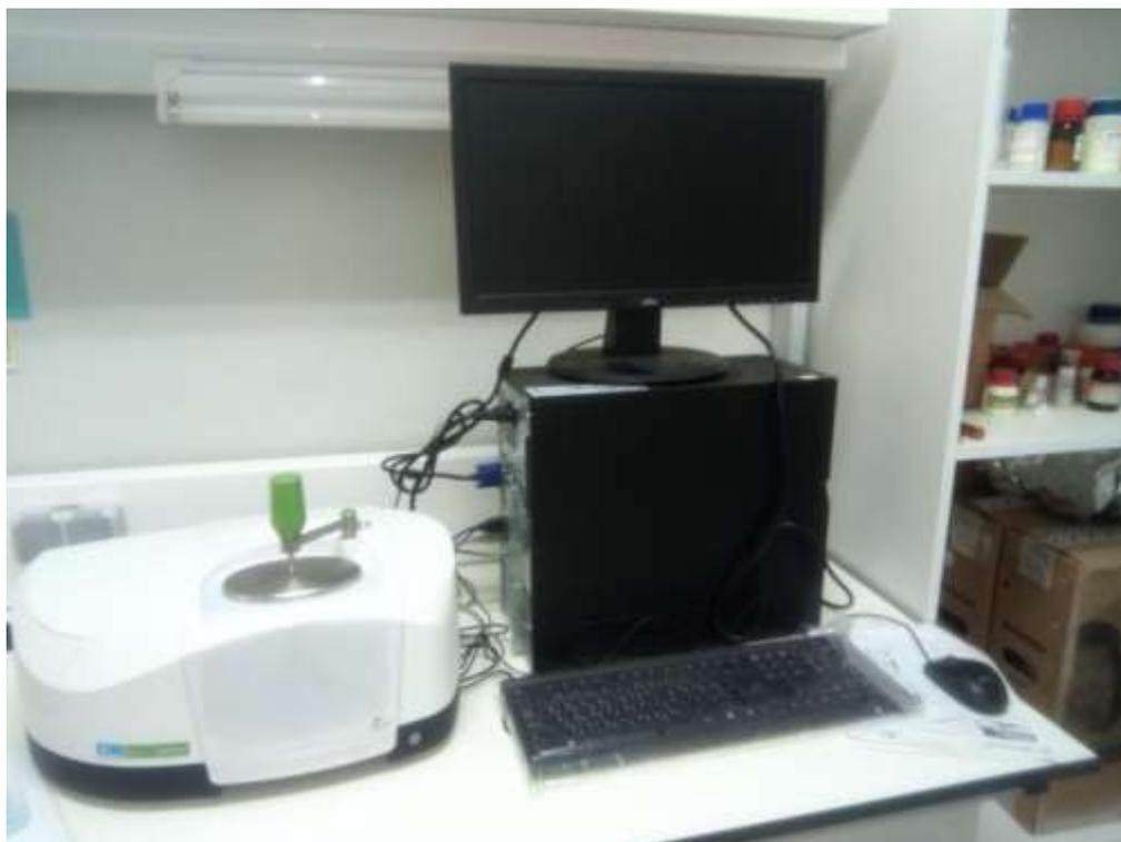
**Figure II.9:** Spectrophotomètre FTIR Perkin Elmer Spectrum Two.
