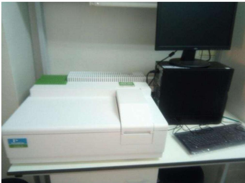
**Figure II.12:** Spectrophotomètre UV-Vis Perkin Elmer Lambda 35.
