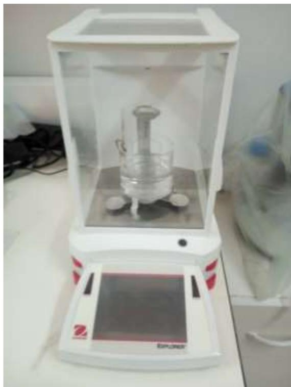
**Figure II.8:** Dispositif de la mesure de la densité des verres.
