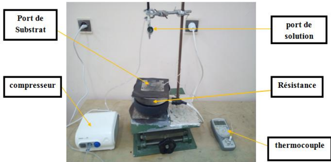
Figure II.1: Montage expérimental du système de spray pneumatique
