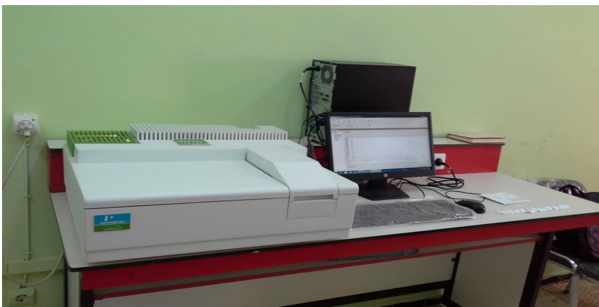
Figure II.8. Représentation schématique du spectromètre UV-Visible. [1]
