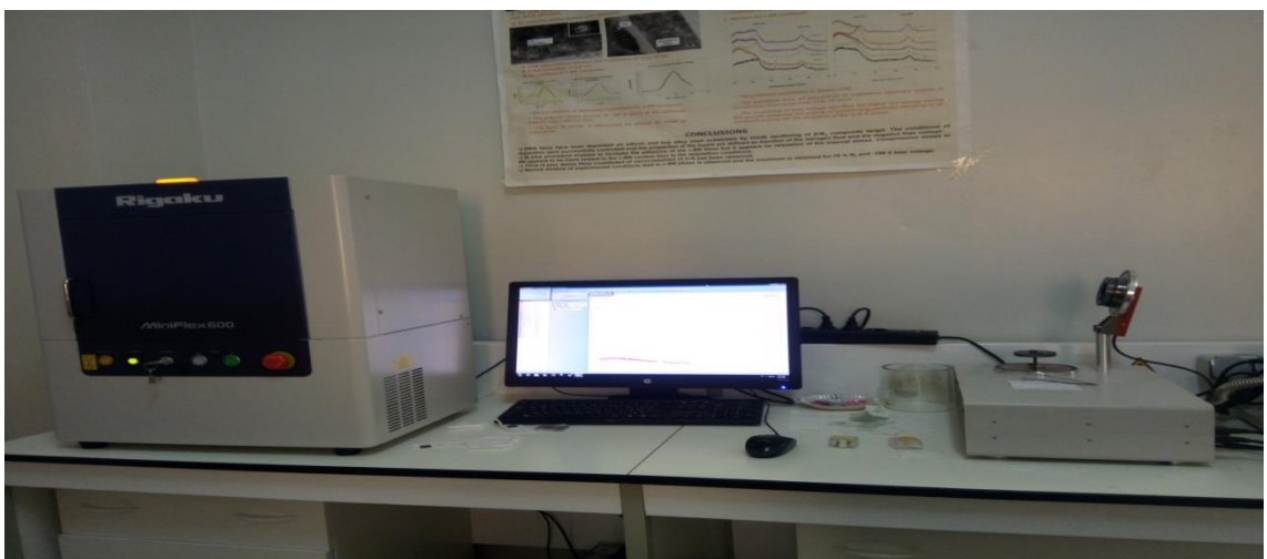
Figure III . 2 : Diffractomètre de type Rikagu miniflex600 (XRD)
