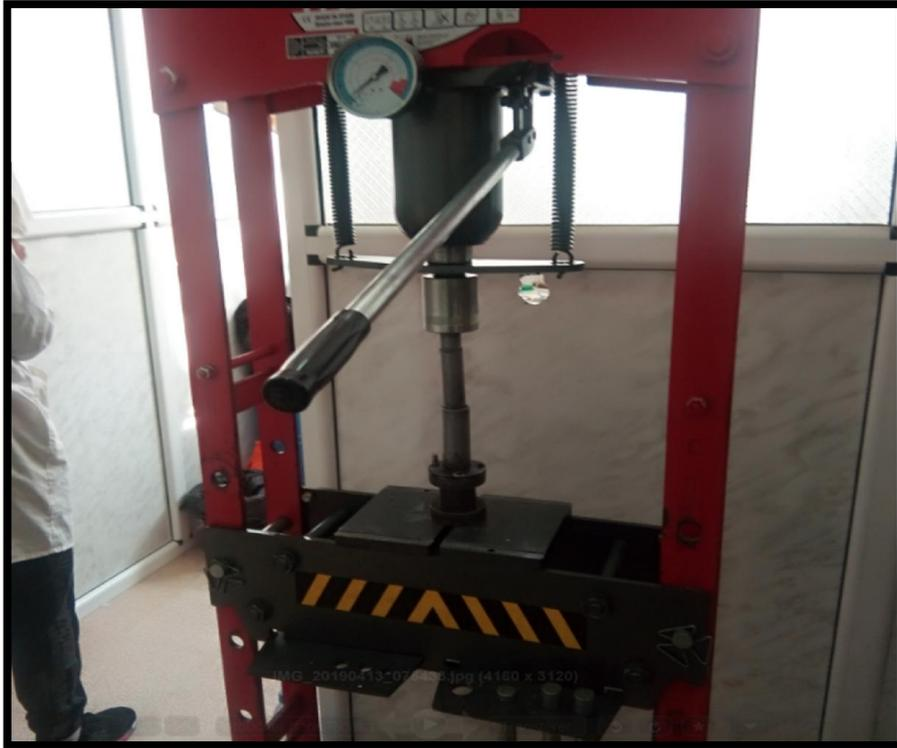
الشكل ( II-17 ) : صورة لجهاز الاستخراج (البثق) .
