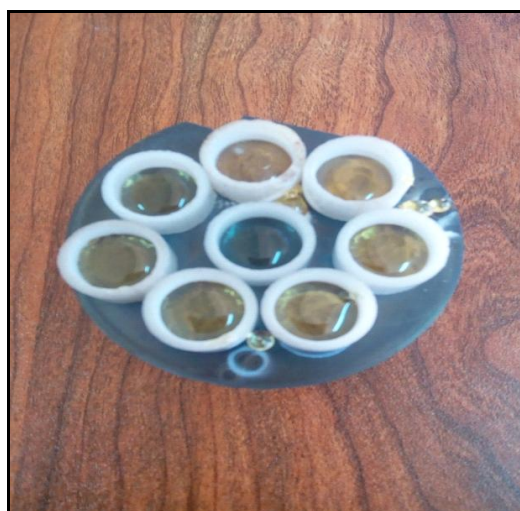
الشكل II-3 : صورة فوتوغرافية توضح عينات الزجاج بعد إخراجهم من الفرن.
