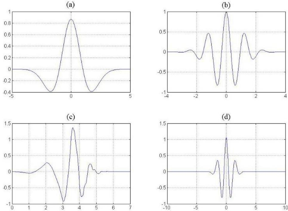
**Figure II.5.** (a) Mexican Hat Wavelet (b) Morlet Wavelet (c) Daubechies Wavelet db4 (d) Gaussian Wavelet [18].
