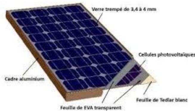
(Fig.1.6) Module photovoltaïque.
