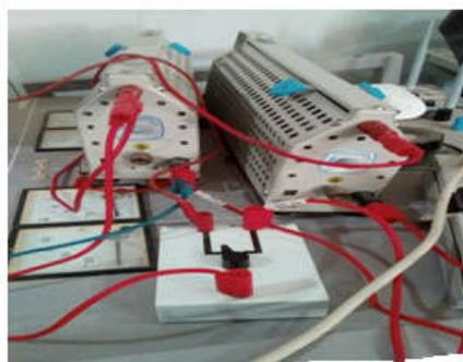
Fig. III.10: Commutateur bidirectionnel permettant la commutation entre l'état sain et déséquilibrée
