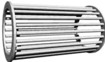
**Figure I.3 :** Rotor à cage d'écureuil
