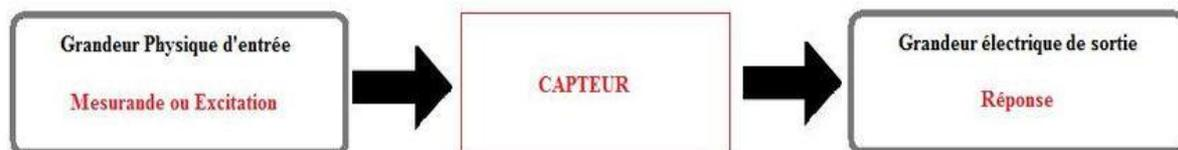
**Fig.I.1.** Rôle général d'un capteur.
