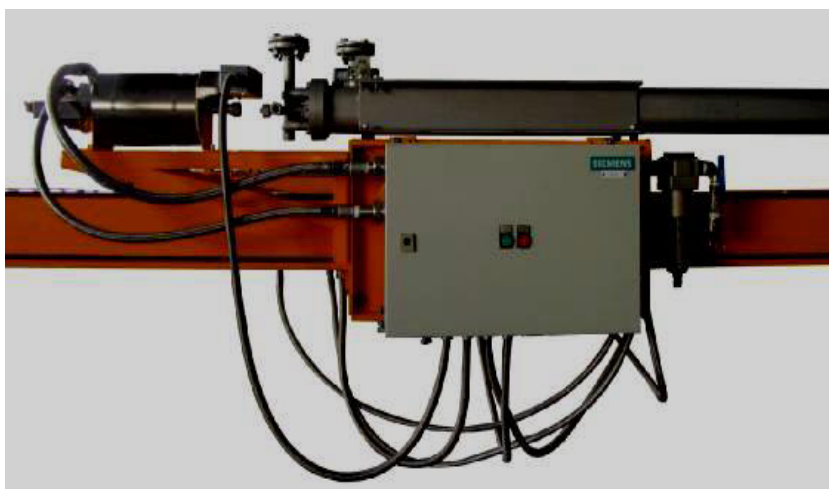
Figure II.9 : Dispositif de purge sur le dispositif télescopique. [7]
