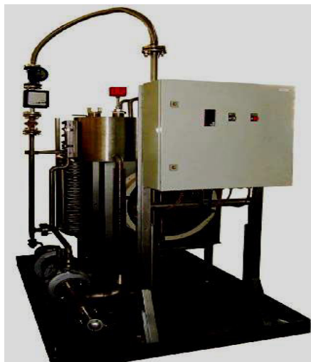
Figure II.7 : L'échangeur de chaleur. [7]
