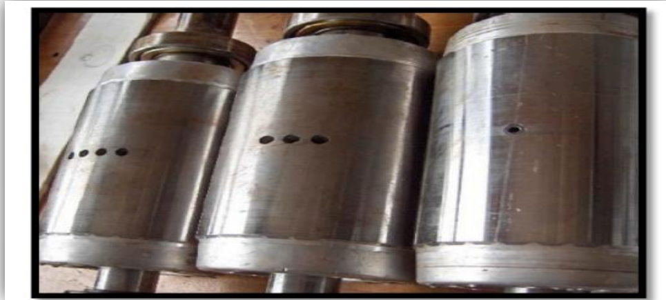
Fig. I.8 : Rupture de barre [6].
