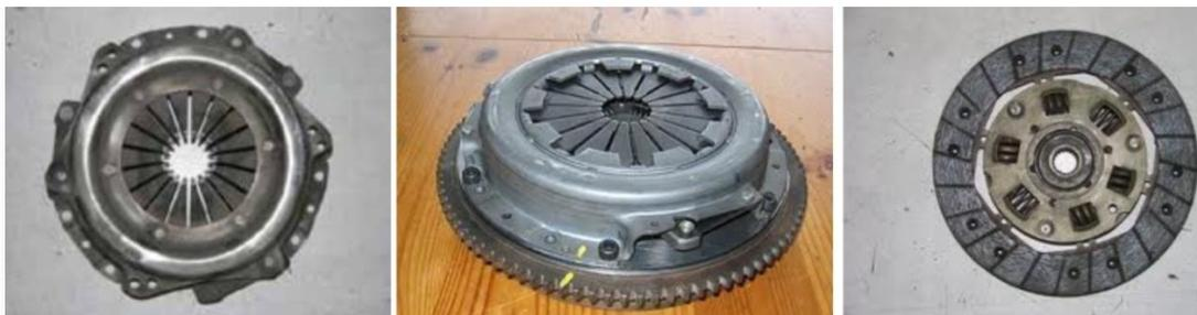
Figure I.23 : Vue complète de l'embrayage, du carter et du diaphragme ainsi que du disque d'embrayage
