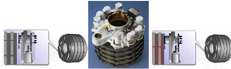
Figure 1.11 : Système de freinage électro-mécanique du Boeing 787 (Messier Bugatti).
