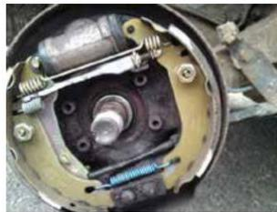
Figure I.16 : Frein à tambour de véhicule automobile
