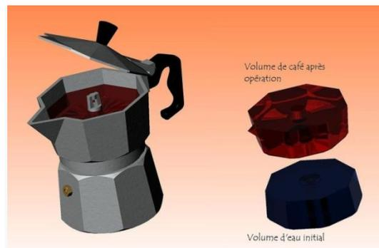
Figure III.5 : L'eau et le café sont définis par des pièces créées dans l'assemblage. Leurs formes sont entièrement liées aux pièces de la cafetière. Elles sont obtenues en seulement 2 opérations : la création du plan supérieur (niveau) et l'empreinte de la cafetière (frontière). Une seule cote leur est propre : la profondeur, même si elle est contrainte fonctionnellement par certains éléments (soupape et cheminée). En l'occurrence les deux volumes sont identiques à 1 % près.
