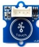
Figure II.18 : Capteurs tactiles.
