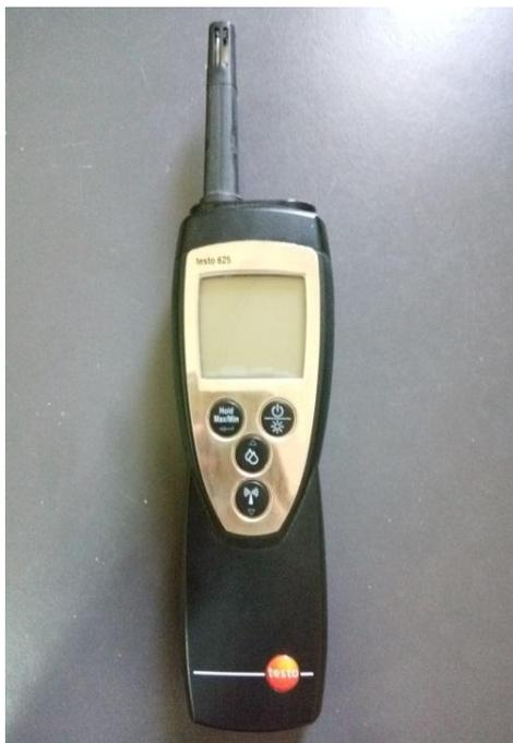
*Fig. III.8. Thermo-hygromètre du type Testo 625.*
