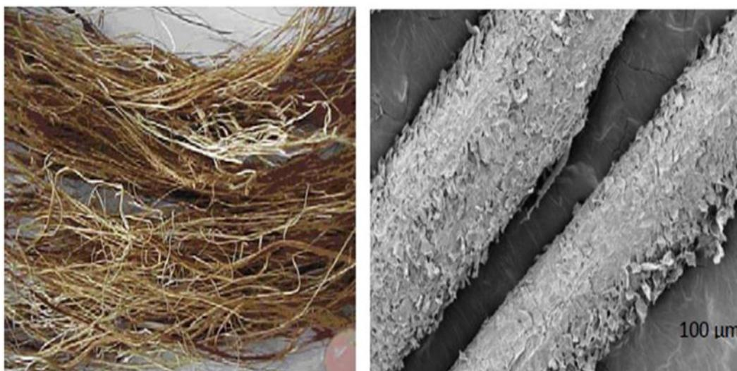
*Fig. I.12. Observation de la fibre de Liffe du tronc par (MEB) (Agoudjil 2011).*
