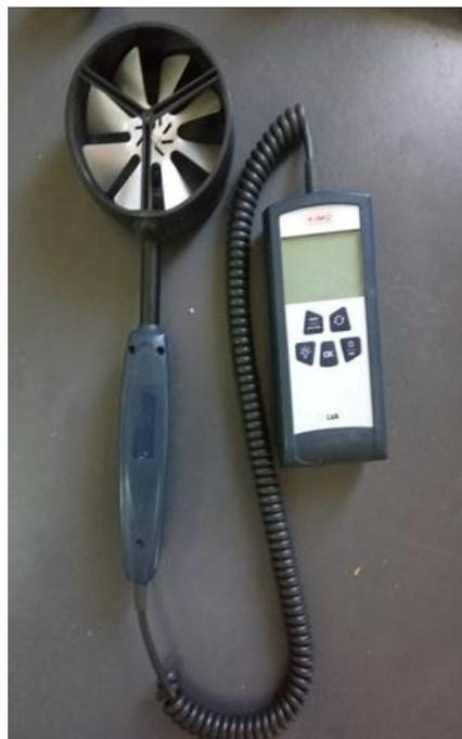
*Fig. III.9. Thermo-anémomètre à hélice du type KIMO LV 110.*
