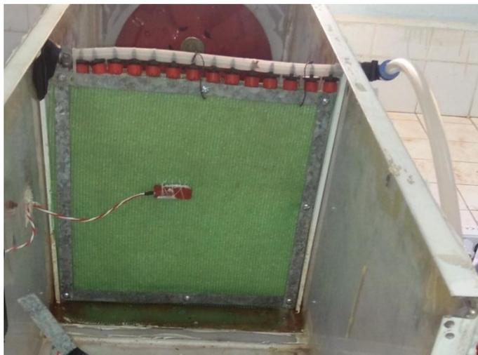
*Fig. III.5. Système d'arrosage de l'enceinte des fibres (Hachaichi 2018).*
