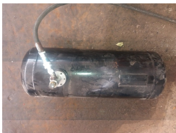
Figure 15. Réservoirs GPLc mises à l'essai de fatigue.
