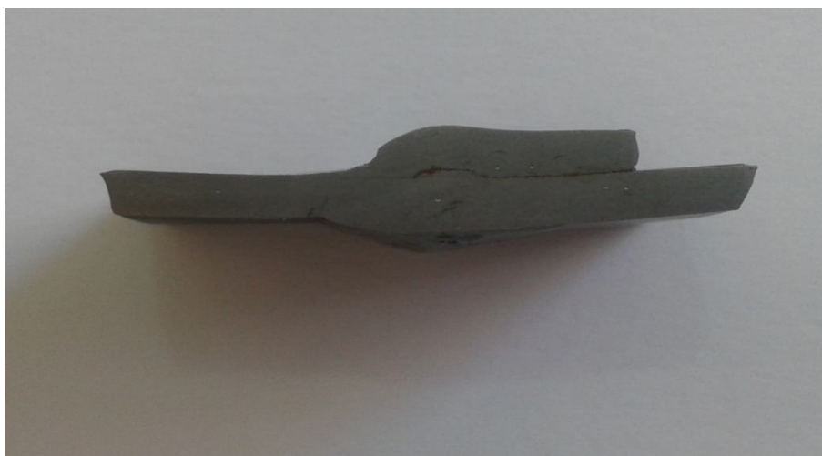
Figure III.16: Type d'échantillon prélevé de la bouteille à gaz B11/13.
