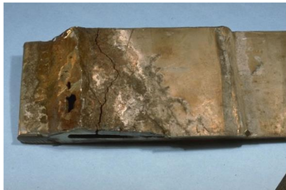
Figure I.14 : La corrosion sous contraintes
