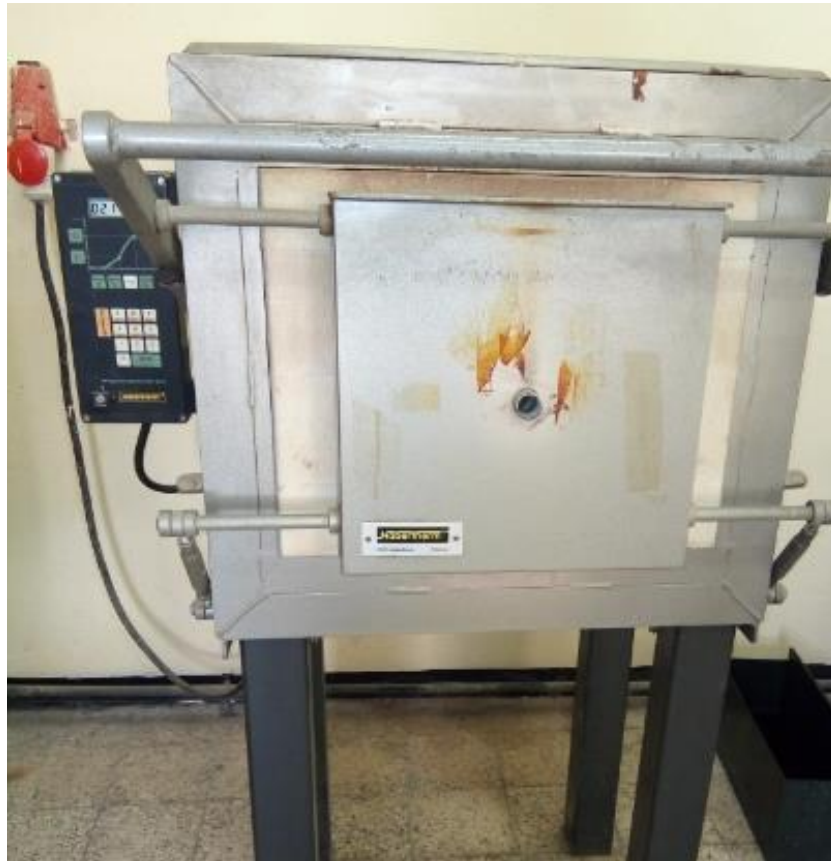
Figure II.2. Le four des traitements thermique NABERTHERM.
