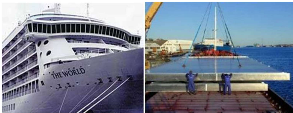
Figure I. 12: a ) Bateau en aluminium construit en utilisant FSW, (b)-Panneaux L'application du procédé RFW [1].
