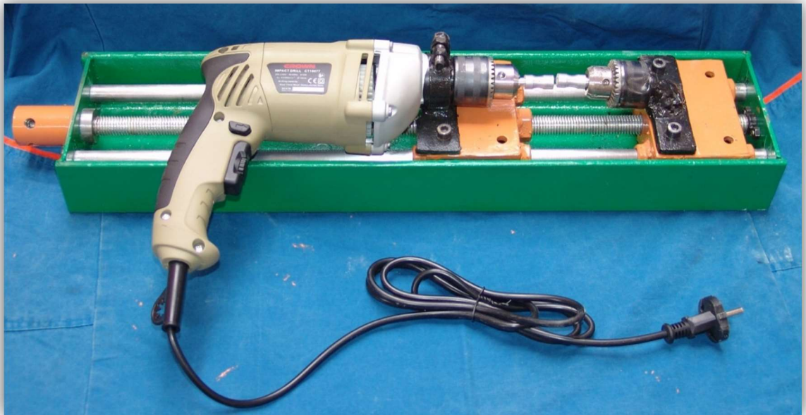
Figure III. 1:Vue globale de la machine de soudage par friction rotative.
