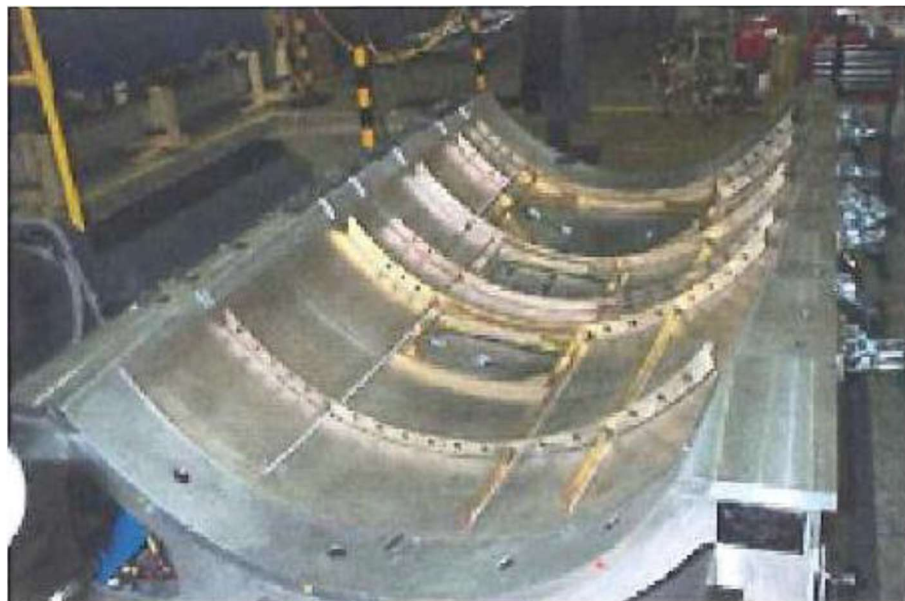
Figure I. 11: Panneau de fuselage soudé par FSW sur Eclipse [18].
