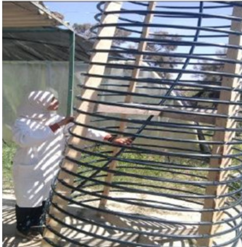
FIGURE 2.13 – L'échangeur sous forme de corbeille.
