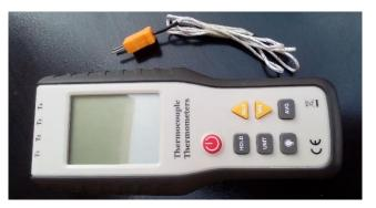
Fig (III-11): A thermocouples type k.
