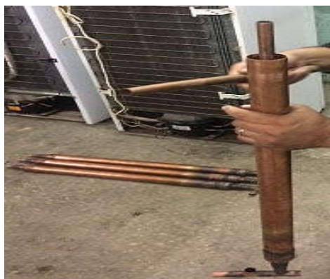
Figure 2.9. Soudage du premier coté et remplissage de charbon actif.
