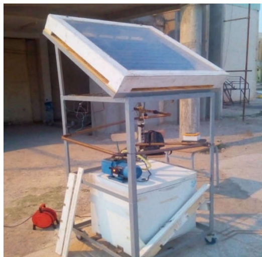
Figure 2.1 Machine frigorifique solaire à adsorption méthanol/charbon actif.
