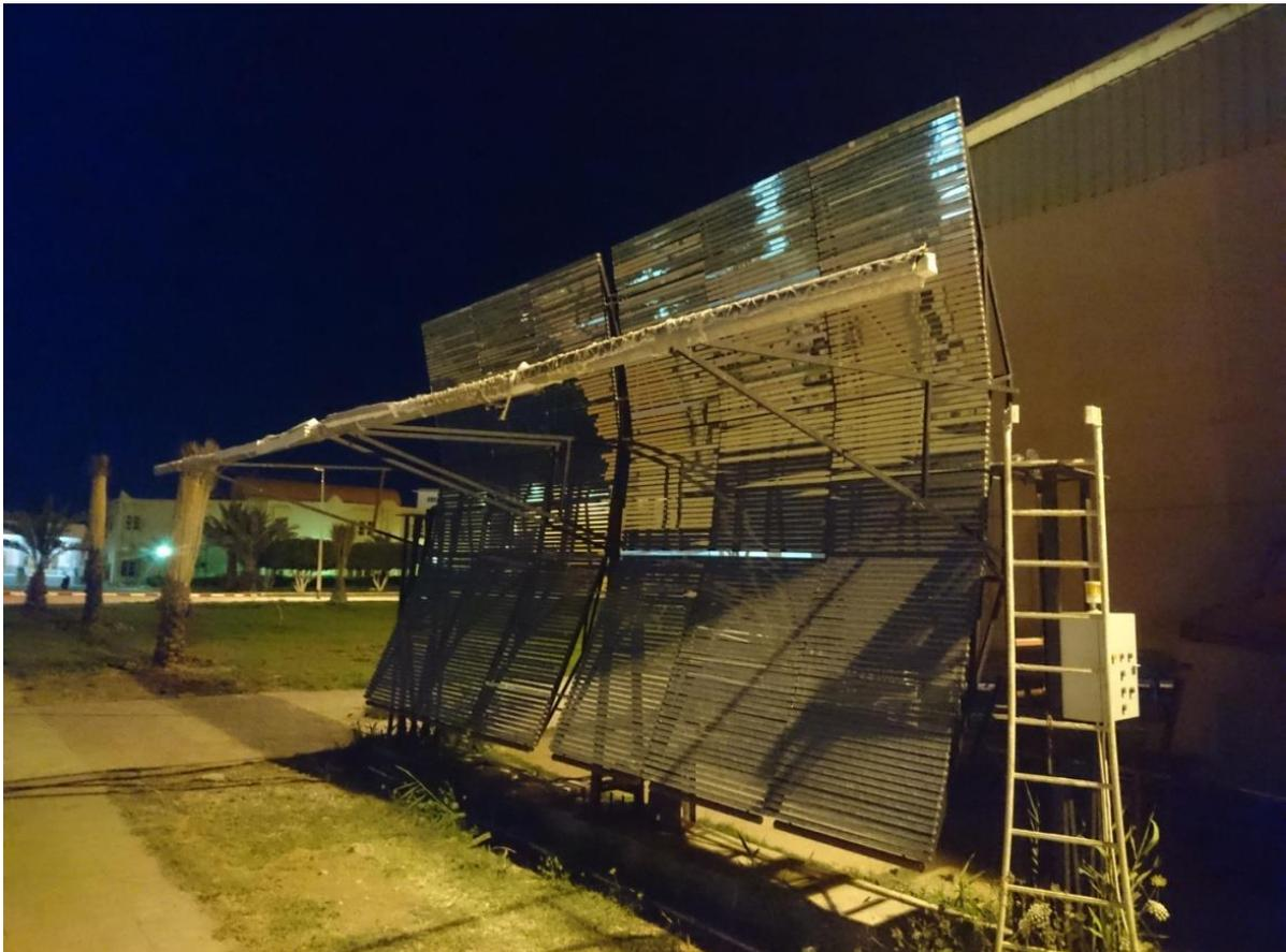
**Figure 3.1.** Réflecteur cylindro-parabolique.
