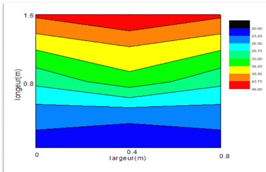
Figure IV-12 : Distribution de la température de l'air dans canal d'écoulement selon le plan (x, y), \dot{m}= 0.0264 ( kg/s).
