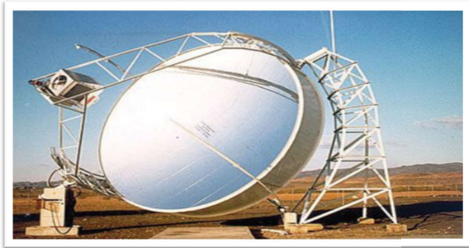
Figure I-8: Capteur parabolique avec moteur Stirling [9].
