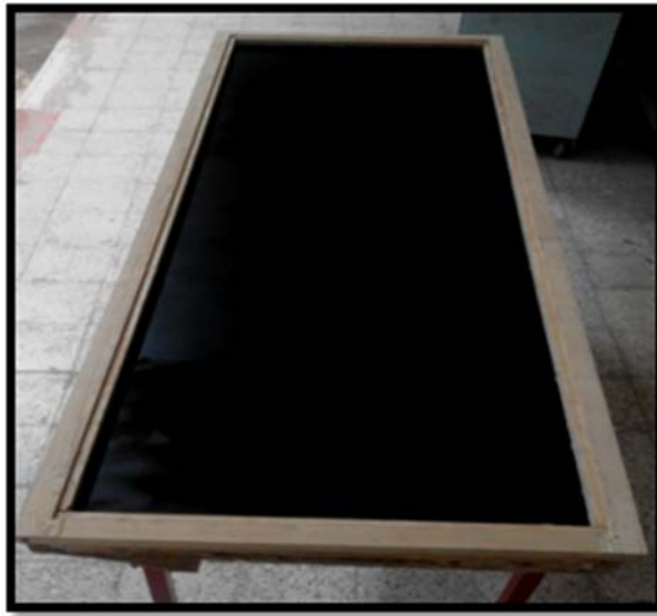
Figure(III.3): plaque absorbante en acier galvanisé peinte en noir mat
