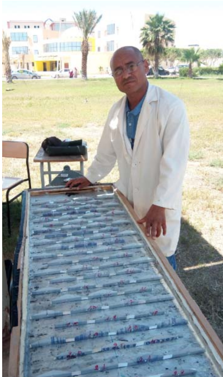
Figure(III.5): chicanes rectangulo-triangulaires en aluminium perforées au milieu du rectangle disposées en quinconces
