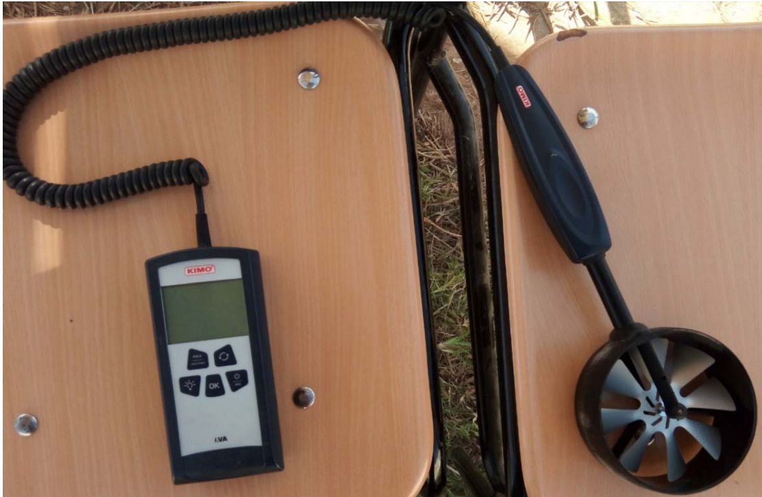
Figure(III.10): Anémomètre à coupelles pour mesurer la vitesse à la sortie du panneau (Plages de mesure: vitesse de 0-35m/s, Résolution 0,1m/s)
