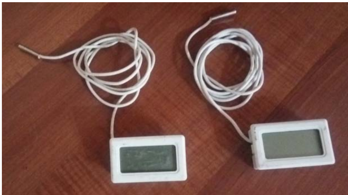
Figure(III.9): Thermocouples pour mesurer la température d'entrée et la température de sortie du panneau solaire
