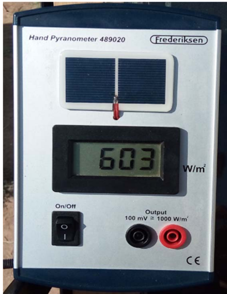
Figure(III.6): Pyranomètre manuel avec écran d'affichage à cristaux liquides pour mesurer le rayonnement solaire (Plage de mesure:0-1999W/m 2 .Résolution:0,1w/m 2 )
