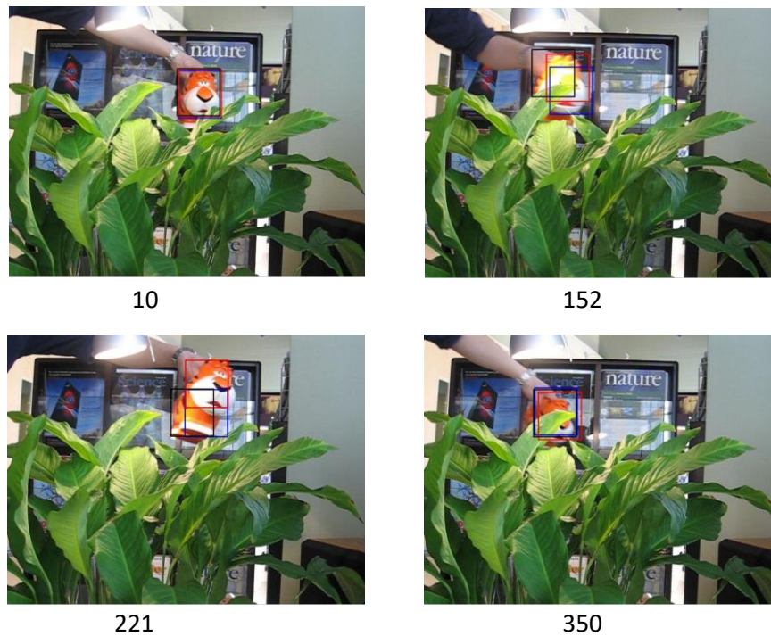
Figure 3.12 : Résultats de suivi sur la séquence Tiger1 avec Mean shift (rectangle bleu), BWH (rectangle noir) et CBWH (rectangle rouge).
