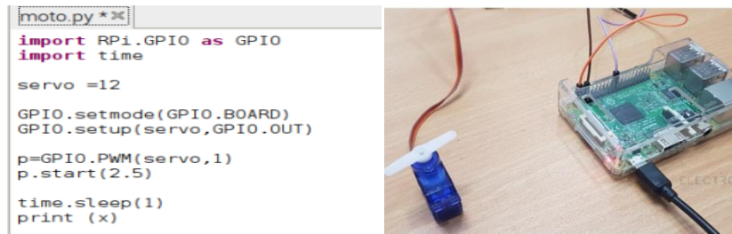
Fig 3.4 : Programme python d'un servomotoravec raspberry pi 3.
