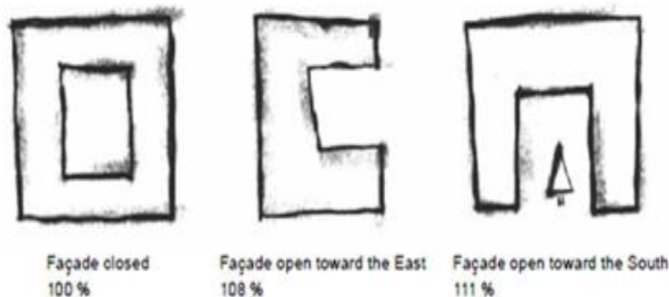
Fig.n°39 : Analyse énergétique des formes de base de la construction Source : Michael. B et al (2010).
