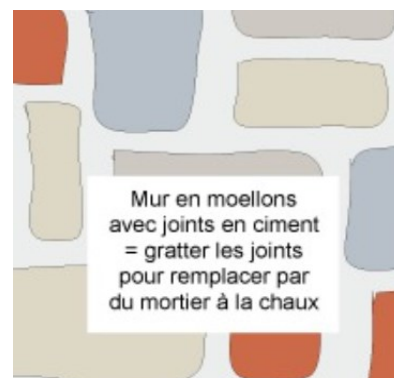
Fig.133 : Le jointage de pierre.
