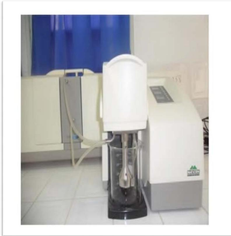
**Figure II.3: Granulomètre laser Malvern Mastersizer 2000/3000.**
