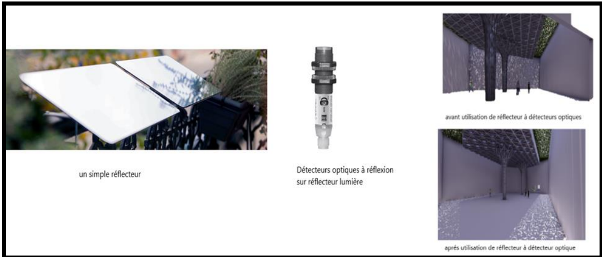
Figure 7_23 : Avant et après l'utilisation de détecteur optique avec la réflexion de la lumière naturelle
