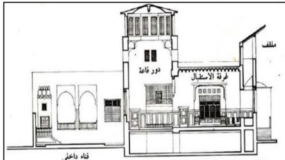
الصورة 03: توضح وظيفة الملقف في التبريد و التهوية المصدر: التصميم البيومناخي كأحدى مبادئ التنمية المستدامة لخلق فراغ داخلي معاصر
