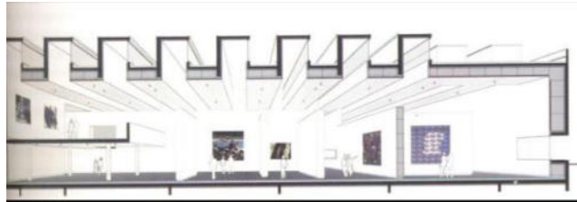
Figure 61:les lanterneaux (Source : http://dispositif.eclairage.archi.musee.fr )
